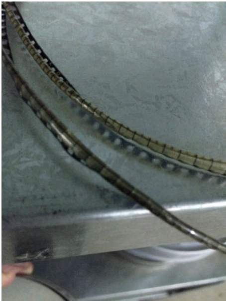
Imagen 22: Soporte de acetato deformado y encogido. Presenta síndrome de vinagre. Familia Flanders.
