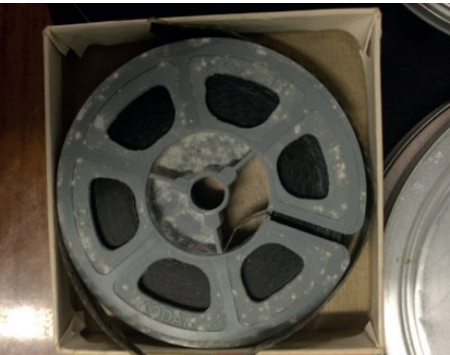
Imagen 23: El almacenamiento en lugares oscuros y húmedos produce colonias de hongos en la película y en sus envases. familia Francia.
